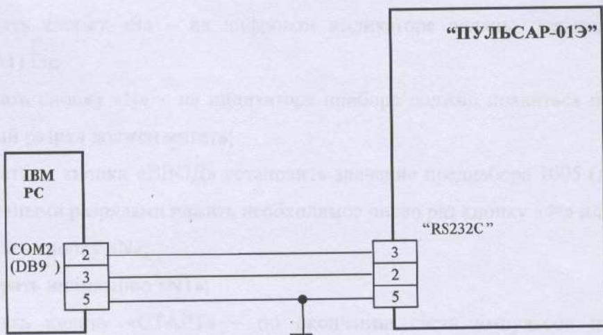
Рисунок 1 – Схема подключения для проверки версии программного обеспечения
