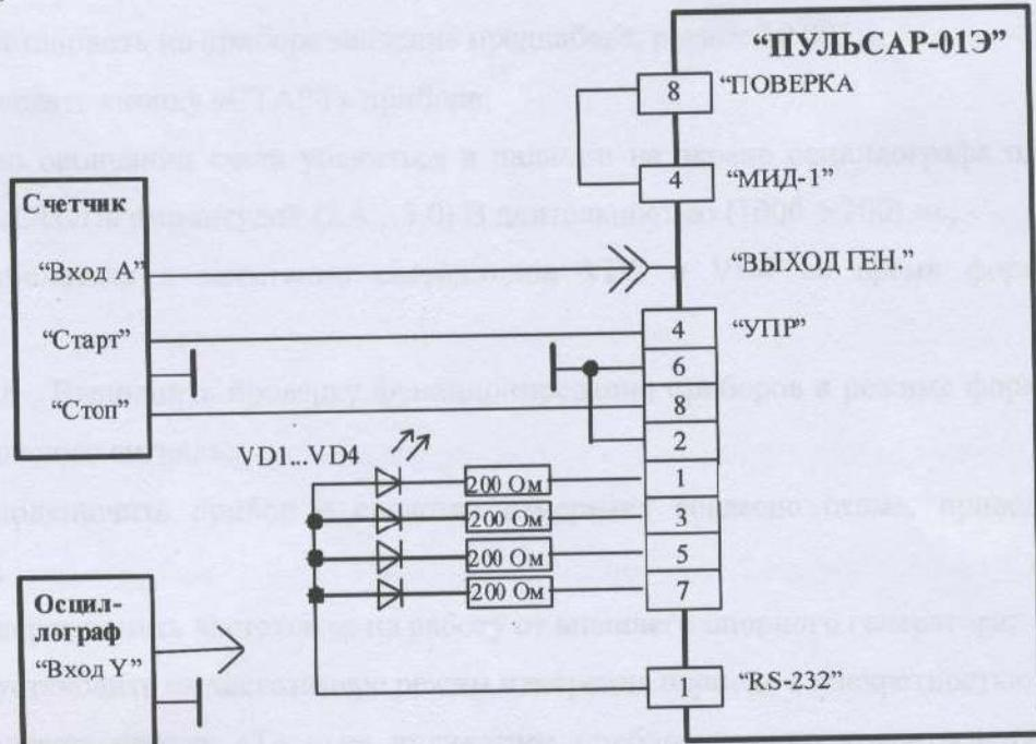
Рисунок 4 – Схема подключения для проверки в режиме формирования сигналов «СТАРТ» и «СТОП»
